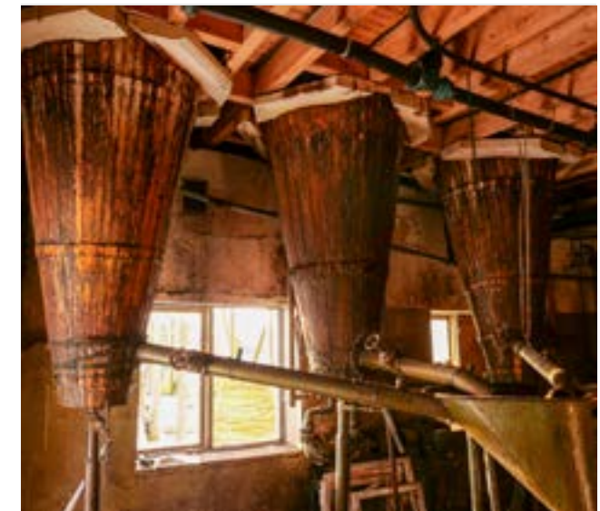
Undersiden av spisskarene i trandamperiet. Ferdigvasket og rensset levermasse ble lagt i karene. Steamrørene slapp damp inn i spisskarene og leveren ble hurtig varmet opp. Foto: Dieter Salathe
