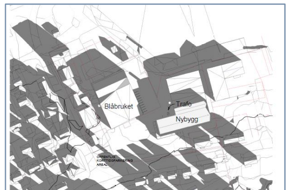
Figur 17: Utsnitt fra Sol/skyggeanalyse for 22. september Kl. 18:00, viser at planlagt nytt bygg ikke vil gi skygge til omkringliggende bygg på naboeiendommer (iVest Consult)
